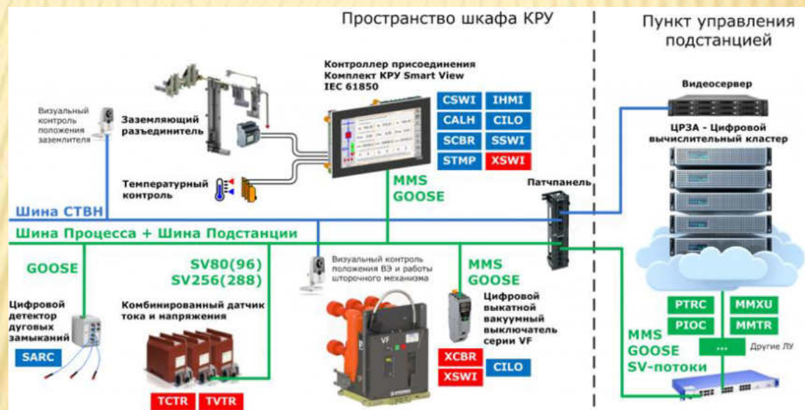
Рисунок 8 - Изображение подстанции с использованием IEC 61850
